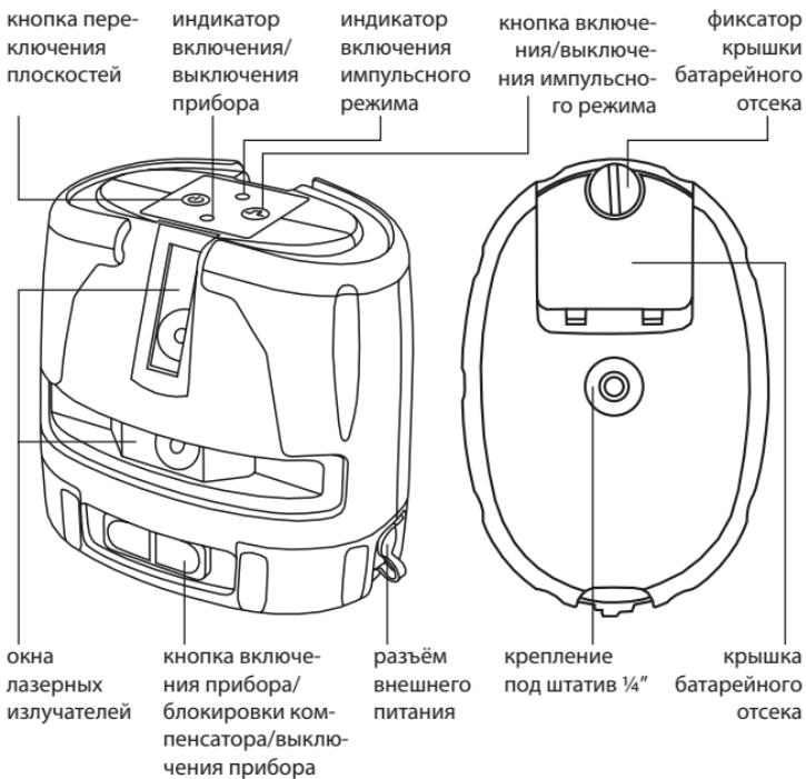
Кнопка переключения лазера служит для попаременной или одновременной проекции лазерных плоскостей.
