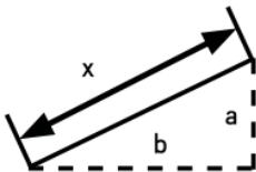
3. Нажмите трижды кнопку , и на экране появится с мигающей гипотенузой. Сначала нажмите кнопку для измерения расстояния (a), затем ещё раз нажмите для измерения расстояния (b) и третий раз нажмите для измерения расстояния (c). Расстояние (x) будет подсчитано автоматически.
