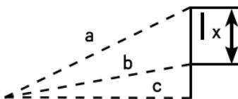
4. Нажмите четыре раза кнопку , на экране начнёт мигать одна гипотенуза. Нажмите , измерьте длину одной гипотенузы (a). Нажмите , измерьте длину второй гипотенузы (b). Нажмите , измерьте длину отрезка (c). Расстояние (x) будет подсчитано автоматически.
