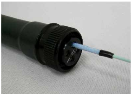
Рисунок 13-8. Очистить все выходы оптоволоконного кабеля с использованием тампонов на стержне, смоченных спиртом.
