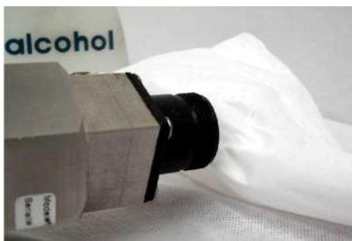
Рисунок 13-5. Очистите выходные разъемы тампонами на стержне, смоченными спиртом.
