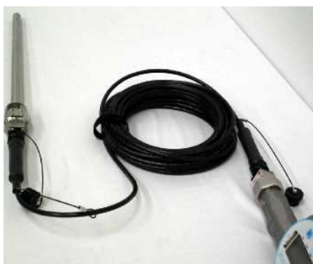
Рисунок 13-9. Оба разъема на концах оптического кабеля соединить с головкой оптического расходомера (зонд) и оптическим устройством обработки данных (процессор), и затянуть от руки.
