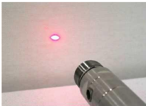
Рисунок 13-12. Лазерные пятна соединяются в одну эллиптическую отметку, когда световое пятно показывается на расстоянии более двух дюймов от колпака. Световое пятно должно быть параллельно расходомерной трубке.
