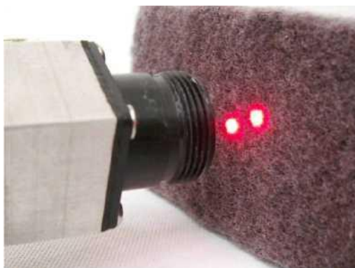
Рисунок 13-6. Выходной разъем лазерного излучения OFP. Два пятна одинаковы, имеют форму круга и высокую яркость.
