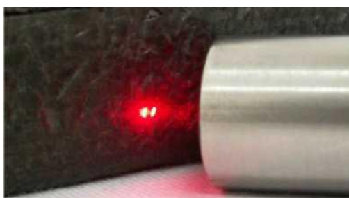
Рисунок 13-11. Пятна лазерного излучения, выходящего из оптической головки расходомера, со снятым колпаком и зеркалом в сборе.
