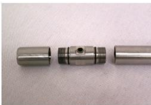
Рисунок 13-10. Часть головки оптического расходомера (зонд) в сборе показана (слева направо) с зеркалом в сборе, колпаком и трубкой. На корпус зонда наносятся юстировочные отметки для правильного совмещения при повторной сборке. Эти детали должны затягиваться только усилием рук.
