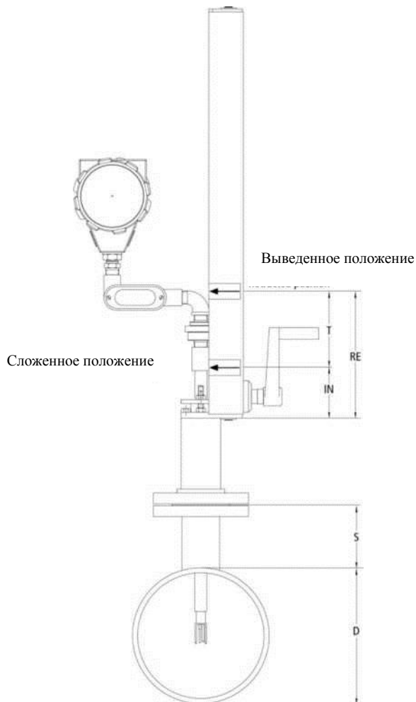
Рисунок 2-3. Глубина вставки при врезке высокого давления
