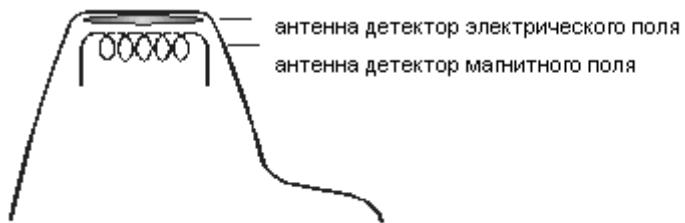
**Рис.3 Размещение антенн детекторов в головке приемника**
