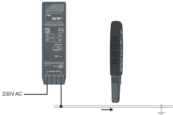
**Рис.27 Трассировка заземленных труб с использованием режима «М»**
