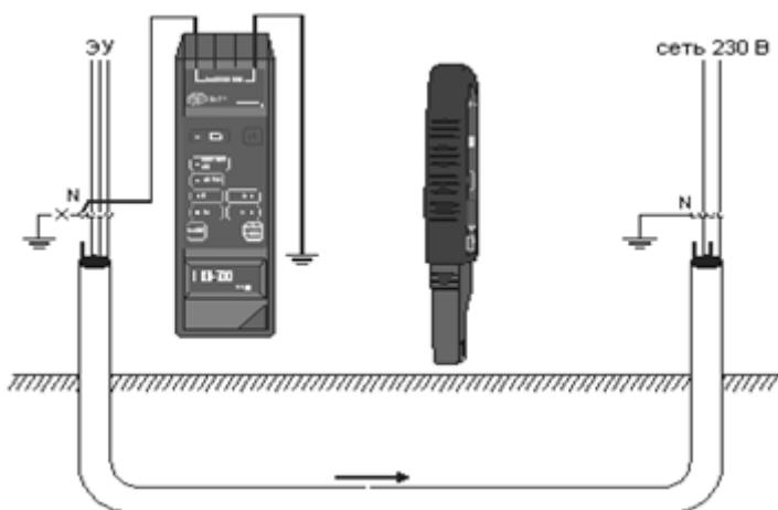
**Рис.15 Поиск кабеля в земле – заземление объекта отключено, режим «ток-напряжение» «M+E» или «силовой» «E»**
