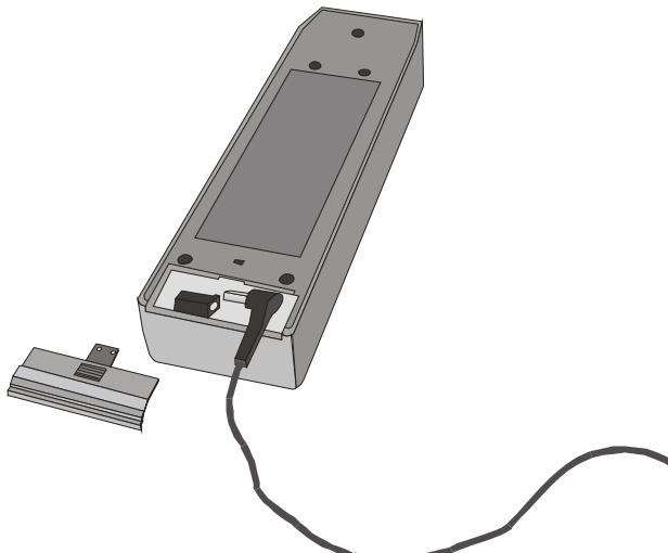
Рис.31. Подключение зарядного устройства для аккумуляторов
