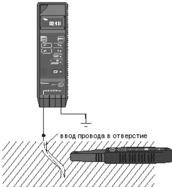
Рис.29 Поиск направления отверстия с использованием режима «Е»
