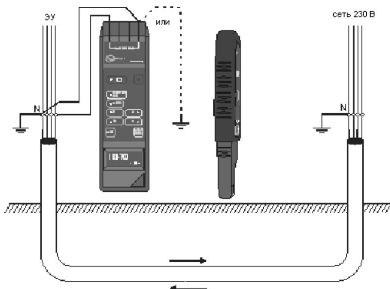
**Рис.16 Поиск кабеля в земле – заземление объекта не отключается, режим «ток» «M»**
