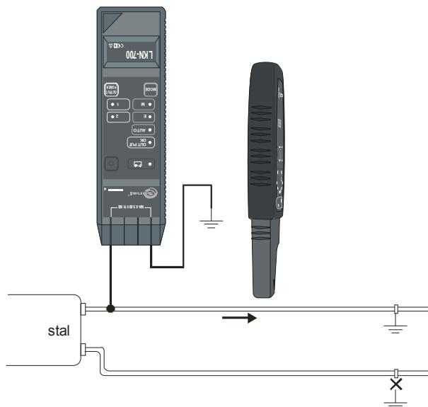
Рис.26 Трассировка заземленных труб с использованием режима «M+E»
