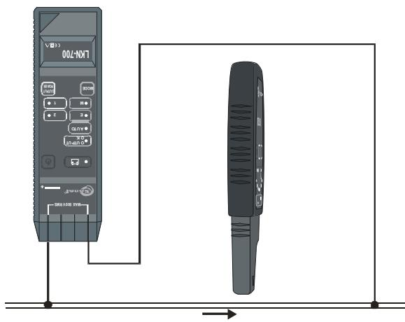
**Рис.28 Локализация незаземленных труб с использованием режима «М+Е»**
