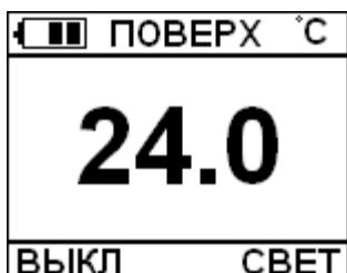
Режим измерения температуры поверхности
