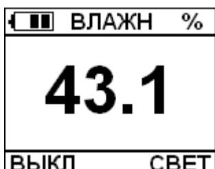
Режим измерения относительной влажности
