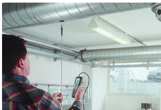
testo 416, используется, например, для наладки притока воздуха в кухонных вентиляционных каналах
