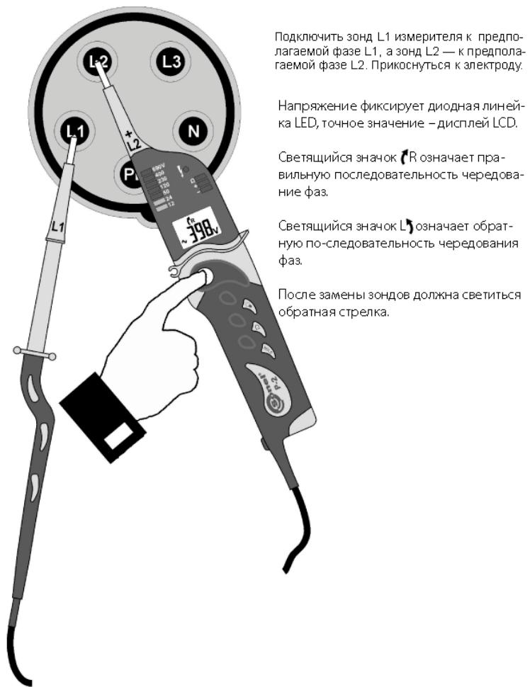
Последовательность чередования фаз можно определить только в трехфазных сетях.
