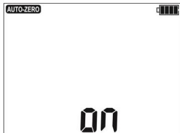
На дисплее появится надпись **AUTO-ZERO** и свидетельствующая о выполнении калибровки измерительных проводов, затем прибор переходит в режим измерения.
