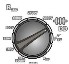
Установите поворотный переключатель выбора функций в положение **DD**. Прибор находится в режиме измерения напряжения
