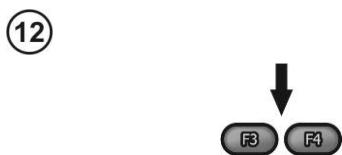
Клавишами **F3** и **F4** (ЭКРАН) можно просматривать отдельные составляющие в порядке:  $R_{iso} \rightarrow I_L$  и  $C \rightarrow Rt1$  и  $It1 \rightarrow Rt2$  и  $It2 \rightarrow Rt3$  и  $It3 \rightarrow Ab1$  ( $DAR \rightarrow Ab2(PI) \rightarrow R_{iso}$  → лимит (только MIC-5010)), где  $C$  – емкость тестируемого объекта.
