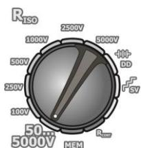
Установите поворотный переключатель режимов работы в одну из позиций  $R_{iso}$ , выберите измерительное напряжение (в положении **50...5000 В** выбирается из диапазонов: 50 В...1 кВ через каждые 10 В, 1 кВ...5 кВ через каждые 25 В). Прибор находится в режиме измерения напряжения.
