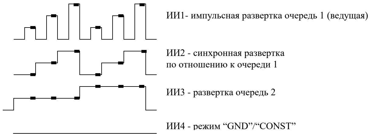
Рисунок 1.13 – Импульсная развертка (очередь 1)
