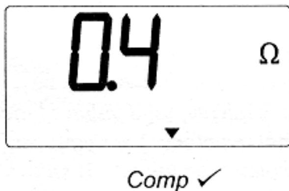
Рисунок. 9. Пример результата испытания на целостность цепи, испытательные провода скомпенсированы
