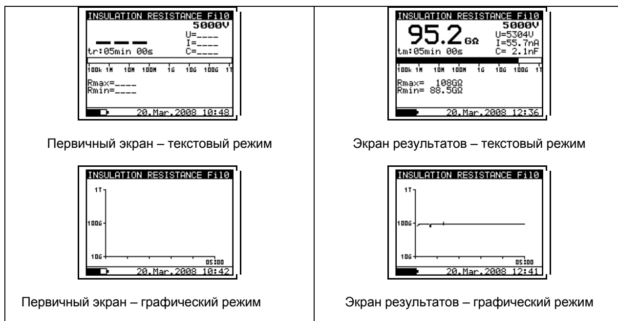
Рис. 12. Вид экрана измерения сопротивления изоляции - функция графика зависимости R(t) активна
