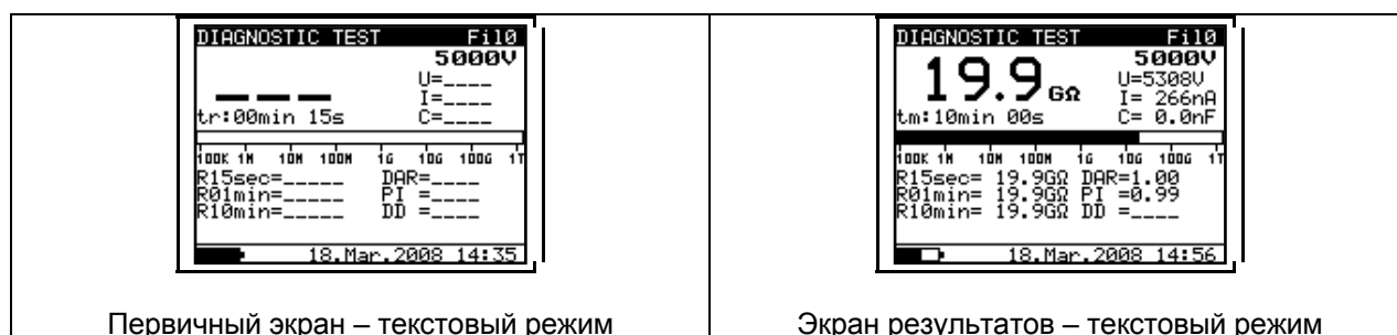
Рис. 16. Вид экрана при диагностической проверке - функция графика зависимости R(t) неактивна
