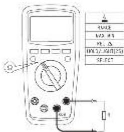
Рис. 4а Измерение сопротивления
