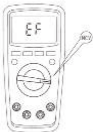
Рис. 11 Бесконтактное обнаружение переменного напряжения
