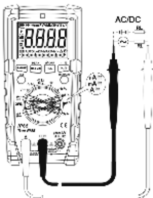
Рис. 10 Измерение силы переменного и постоянного тока
