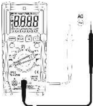
Рис. 4 Измерение напряжения AC в режиме LoZ
