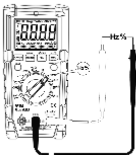
Рис. 8 Измерение частоты и коэффициента заполнения
