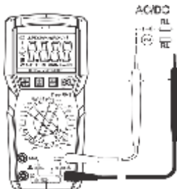
Рис. 10 Измерение силы переменного и постоянного тока
