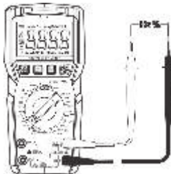
Рис. 11 Измерение частоты и коэффициента заполнения
