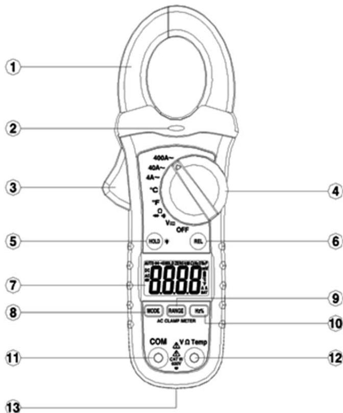
**11** Измерительный разъем **COM**. Общий измерительный вход для всех измерительных функций (кроме измерения тока)
