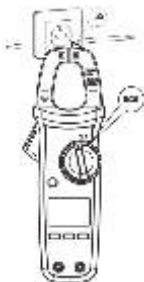
Рис. 5 Бесконтактное обнаружение переменного напряжения
