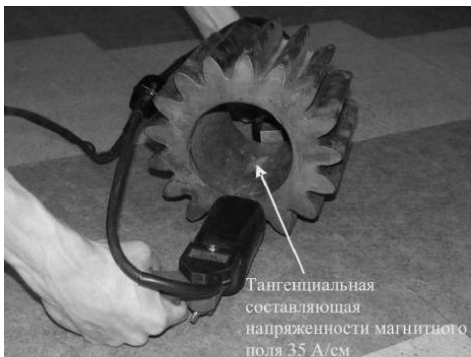
Рис.3 Намагничивание внутренней поверхности шестерни электромагнитом с разъединенными сердечниками
