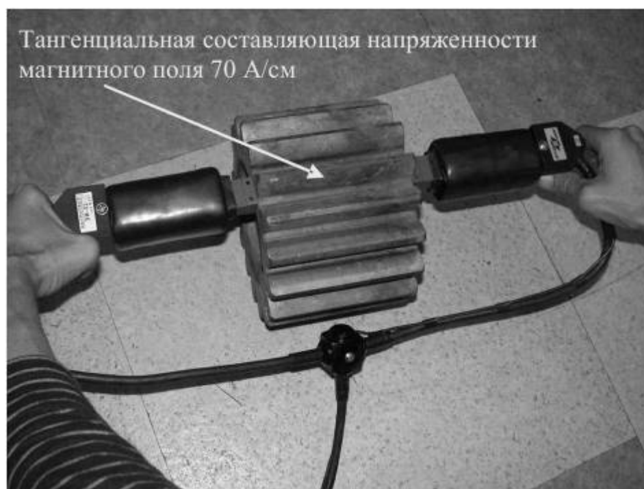
Рис.2 Намагничивание отдельных зубьев шестерни электромагнитом с разьединенными сердечниками
