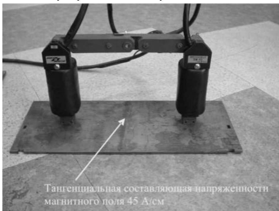
Рис.1 Намагничивание поверхностей простой формы электромагнитом с соединенными сердечниками
