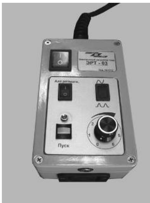
Рис.2 – внешний вид электронного регулятора тока ЭРТ-03
