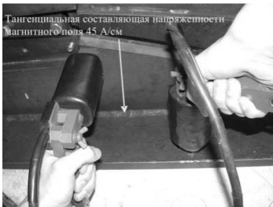
Рис.4 Намагничивание углового сварного шва электромагнитом с разъединенными сердечниками
