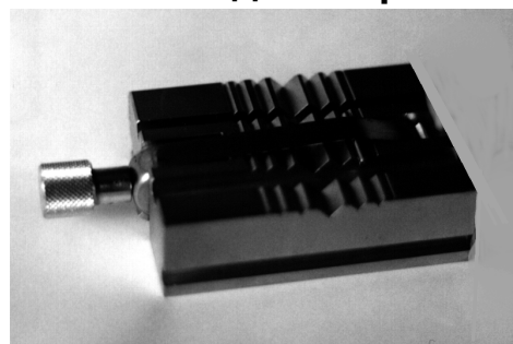
Рис. 16-2 - Зажим для проволоки с V-образными проточками
