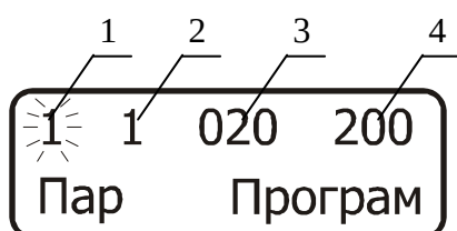
1 – номер программы; 2 – номер этапа программы; 3 – время выполнения этапа в минутах; 4 – температура, поддерживаемая в камере при выполнении этапа в градусах Цельсия
