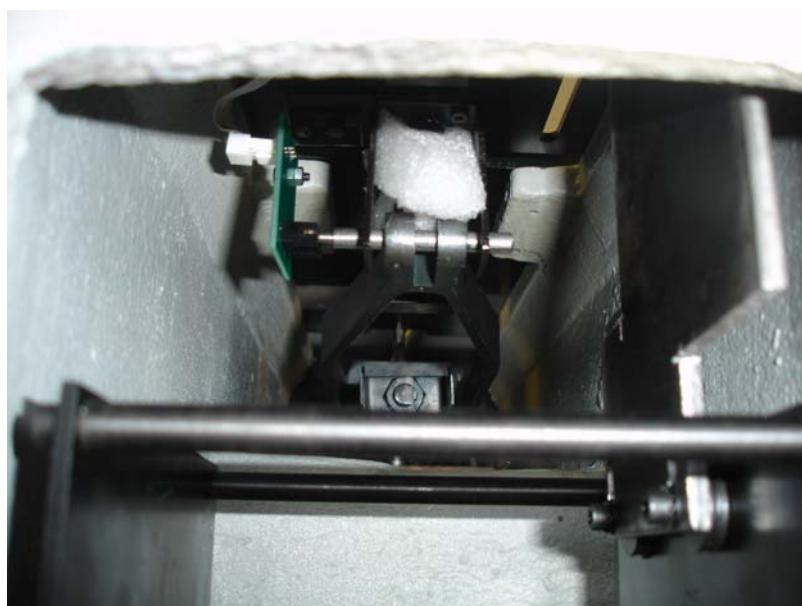
Рис. 9-1-2 удалите крепежные болты между загрузочным рычагом и двигателем нагрузки
