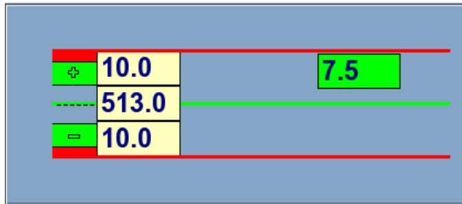
Измеренное (или конвертированное ) значение внутри поля допуска с отрицательной ошибкой
