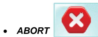
Данная кнопка, используемая в основном во время автоматического цикла, закрывает окно и сохраняет систему в нормальном состоянии. Если нажать ее вне оперативной фазы, она работает тем же образом, что и кнопка RETURN.
