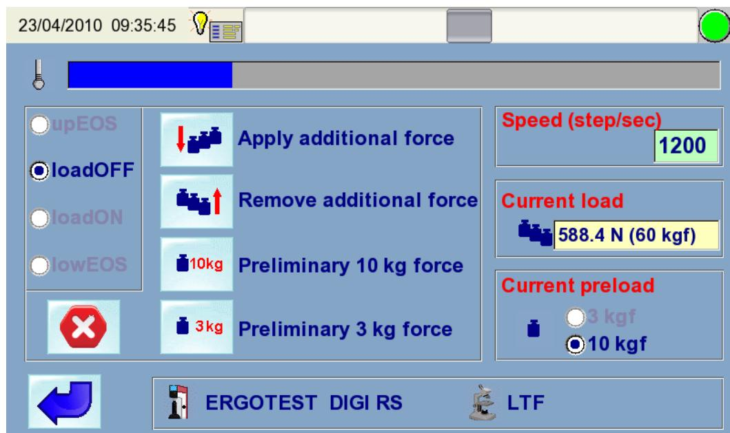
Данная модель имеет контроль предварительной нагрузки; поля, относящиеся к этой функции, показывают два возможных условия (3 кг и 10 кг). Текущая выбранная нагрузка показывается со значениями, относящимися к модели RS.
