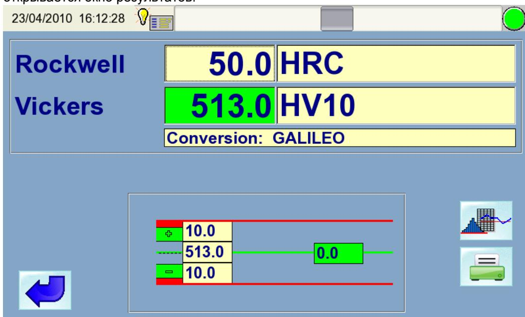
Результат конверсии появляется только если конверсия была предварительно выбрана. В этом случае, метод и таблицы используемые для конверсии представляются на экране. В иных случаях это поле остается пустым.
