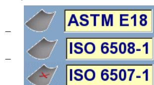
Иконки используются для информирования о криволинейных поверхностях и которые используются в выборе окна для выбора компенсации кривизны поверхности (см.главу 7 CURVATURE CORRECTION DEFINITION (ОПРЕДЕЛЕНИЕ КОРРЕКЦИИ КРИВИЗНЫ ПОВЕРХНОСТИ)Если коррекция кривизны не активирована, следующие поля скрыты.
