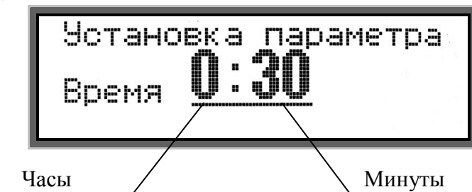
Рисунок 6 – Вид дисплея в состоянии задания времени нагрева
