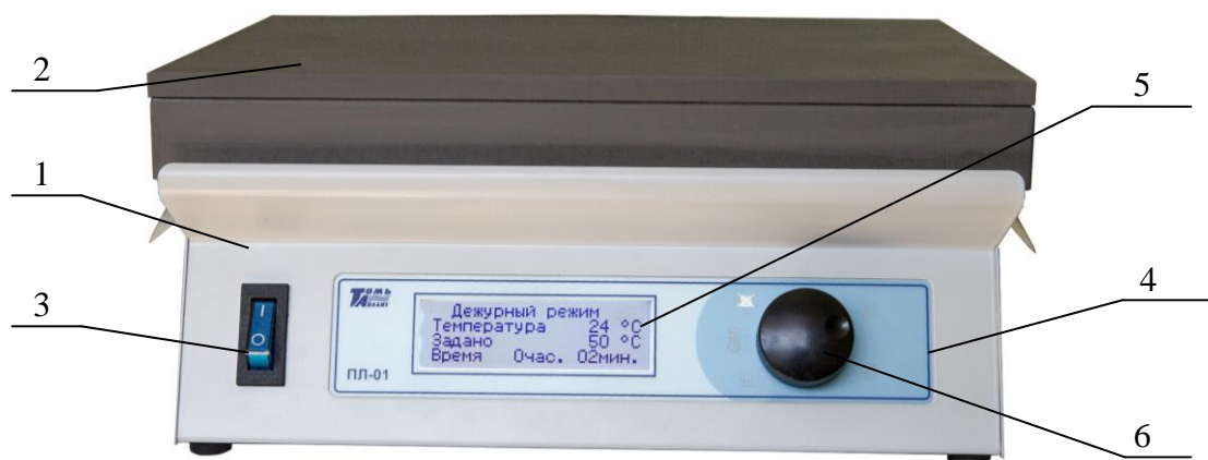
1 – корпус плитки; 2 – нагревательная поверхность; 3 – сетевой выключатель; 4 – панель управления; 5 – дисплей; 6 – энкодер.
