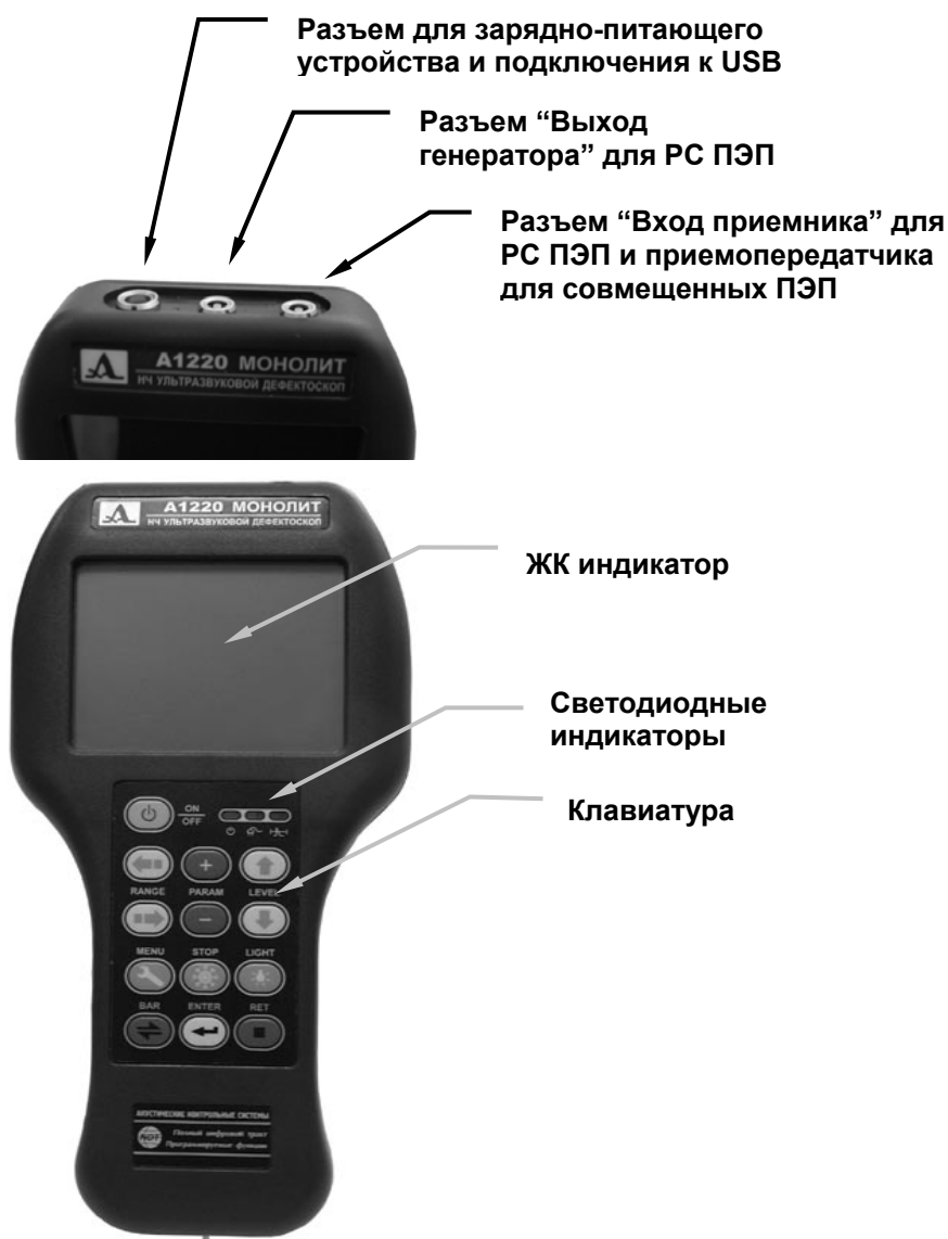
Рис. 2.1. Электронный блок дефектоскопа
