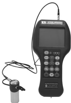
Рис. 4.1 Подключение преобразователя S0205 в совмещенном режиме
