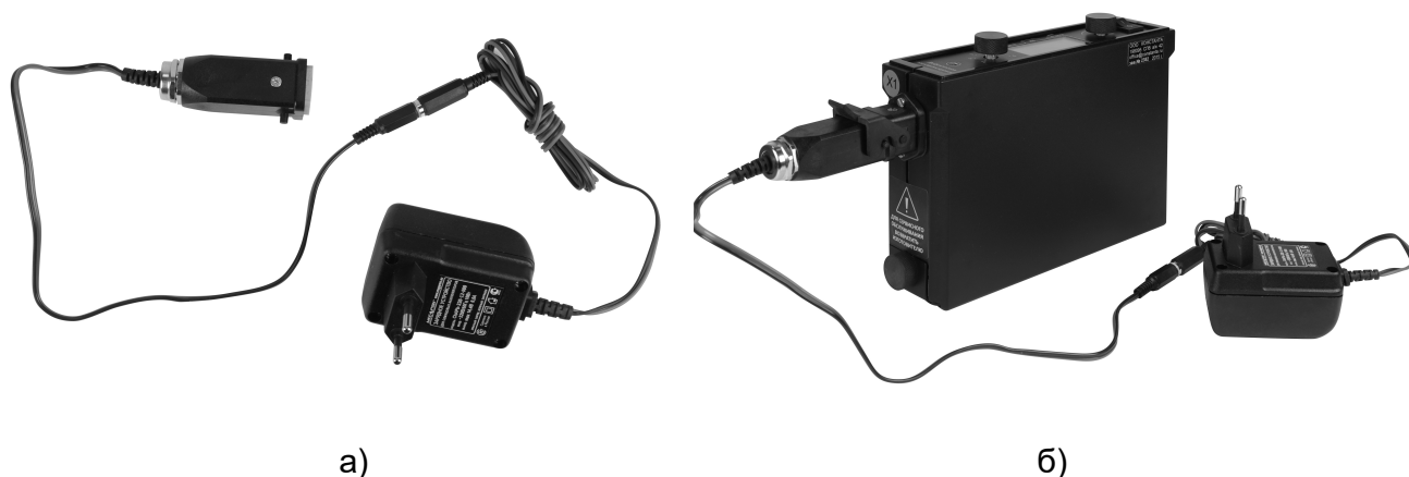
Рис. 29. Заряд аккумулятора в блоке контроля: а) подсоединение соединительного кабеля к переходному разъему; б) подсоединение выходного кабеля зарядного устройства к разъему «X1» блока контроля
