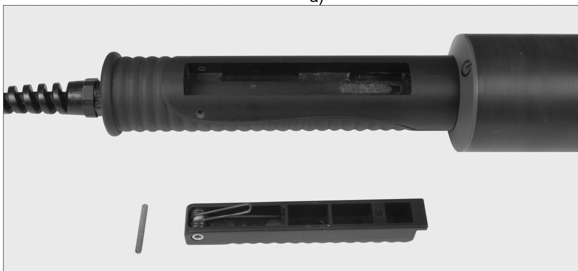
Рис.32. Последовательность действий при снятии кнопки включения: а) откручивание первого винта крепления кнопки; б) откручивание второго винта крепления кнопки; в) высоковольтный трансформатор-держатель со снятой кнопкой
