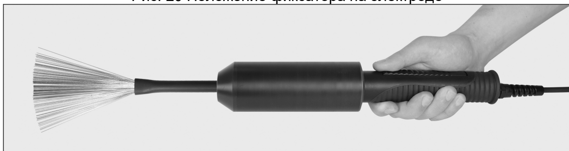
Рис. 21 Положение электрода, закрепленного в высоковольтном трансформаторе-держателе
