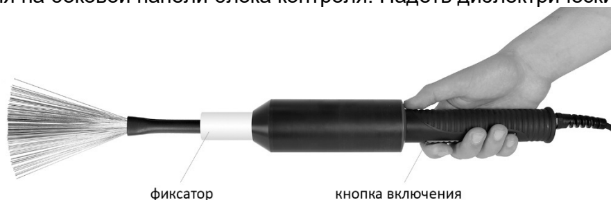
Рисунок 1. Положение фиксатора на электроде
