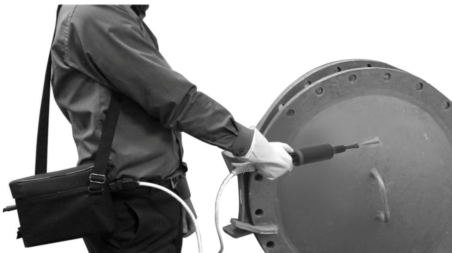
Рис. 22. Положение прибора при проведении контроля
