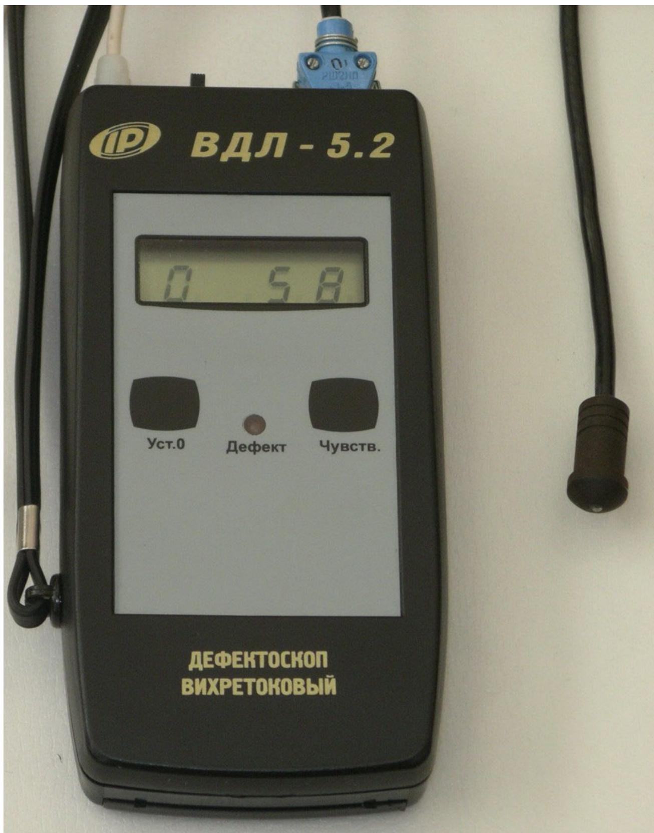
Рис. 3.1 Внешний вид прибора ВДЛ-5.2
