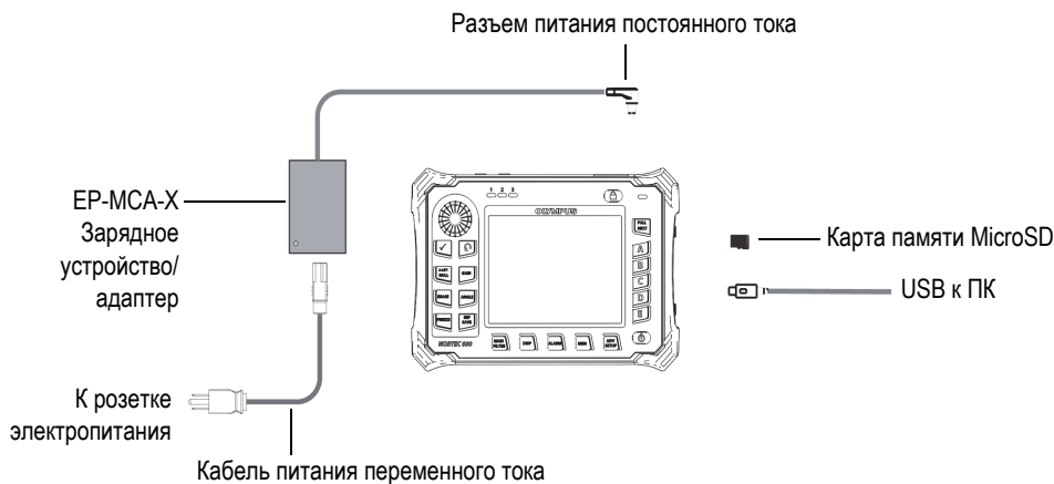
Рис. 1-2 Схема подключения внешних устройств к NORTEC 600
