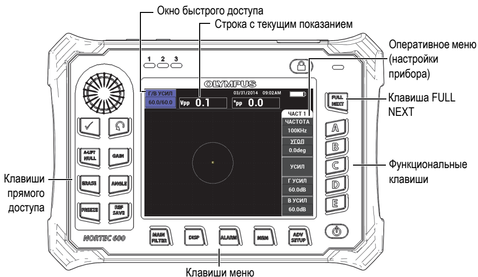
Рис. 2-5 Передняя панель NORTEC 600 и экран измерений
