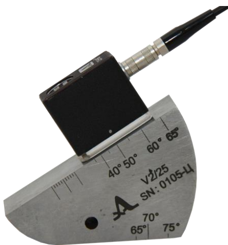
Угол калибруемого ПЭП меньше или равен 62^{\circ}
