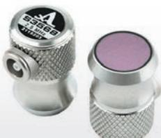
**S3568 2.5A0D10CL** – прямой совмещенный преобразователь с износостойким протектором для дефектоскопии и толщинометрии основного тела толстостенных изделий из металла, чугуна, пластика и других материалов с высоким затуханием ультразвука. Преобразователь позволяет проводить сканирование объекта контроля и экспресс-поиск инородных включений и расслоений основного тела металла.
