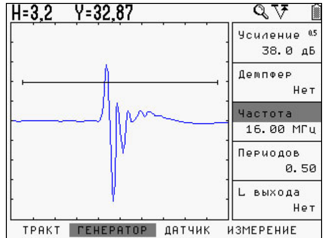
а) Широкополосный преобразователь 15МГц, подключенный без демпфирования
