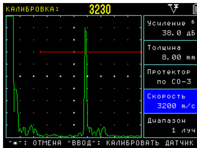
рис.3-13 Калибровка скорости в образце
