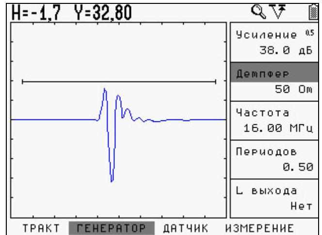
б) С демпфированием генератора 50 Ом
