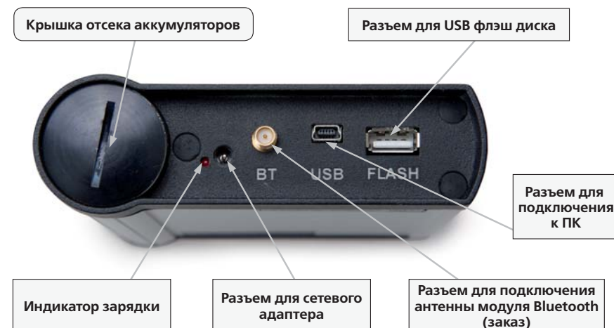
Рисунок 2.2. Нижний фланец прибора
