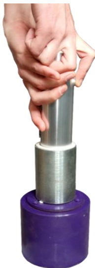
Рисунок 2.1 – Проверка молотка Шмидта на эталонной наковальне
