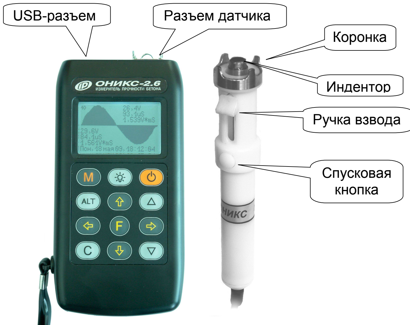
Рис. 3.1. Внешний вид прибора «Оникс-2.6»
