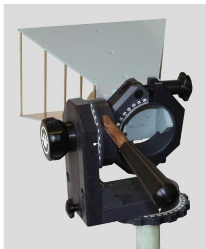
Фото 5. Антенна П6-123 и П6-140 из состава антенного измерительного комплекта АИК 1-40Б/01
