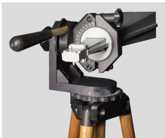
Фото 5. Антенна П6-123 и П6-140 из состава антенного измерительного комплекта АИК 1-40Б/01
