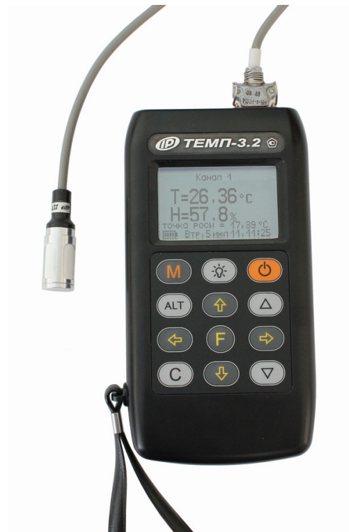
Рисунок 1- Общий вид прибора модификации «ТЕМП-3.20» с совмещенным датчиком температуры и влажности ДТГ
